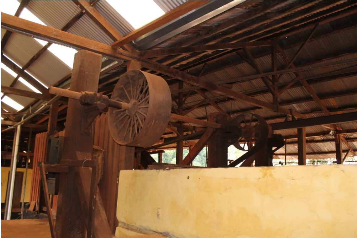
Eixo, polias e correia numa das áreas do engenho
