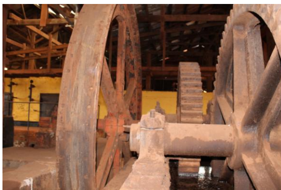
Uma das volandeiras e trem de engrenagens do engenho
