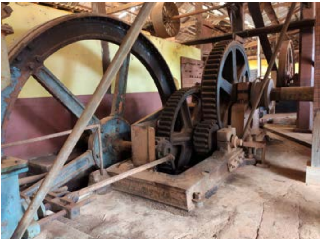
Volandeira de máquina a vapor com engrenagens . Arquivo do museu
